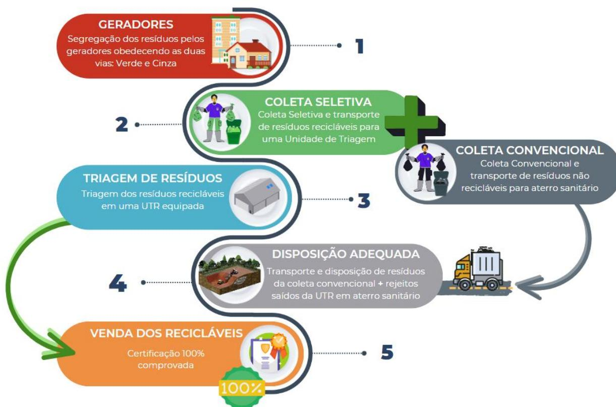
**Figura 9:** Sistema de Coleta Seletiva: Via Verde e Via Cinza.
