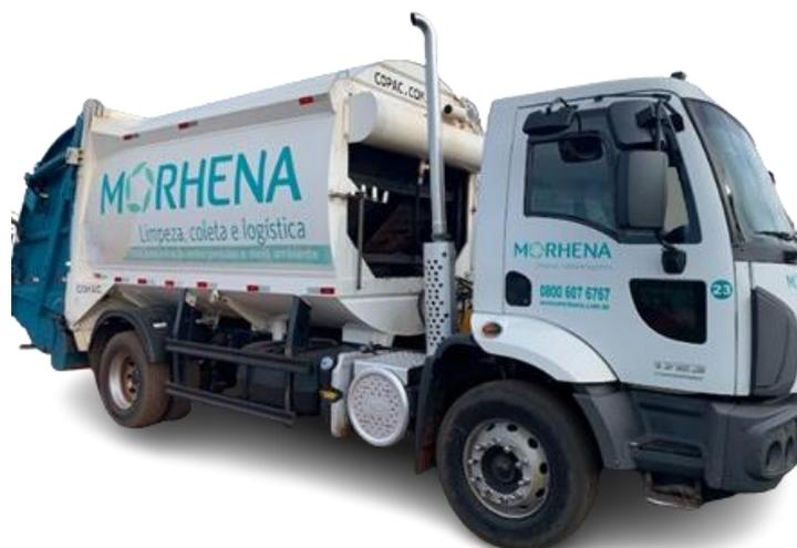
**Figura 4:** Caminhão compactador da coleta de RSD.
